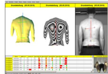
Das Messergebnis der 3D-Wirbelsäulenvermessung: Unmittelbar als 3D-Modell, 2D-Isobarenbild und Foto auf dem Monitor abrufbar.
